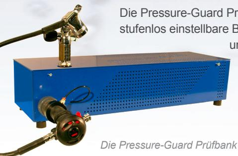
Die Pressure-Guard Prüfbank ermöglicht eine stufenlos einstellbare Beatmungsfrequenz und hohe Exaktheit der Ergebnisse durch Minimierung des Totraumes.
